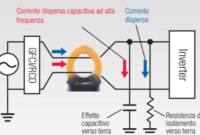
Misura la corrente di dispersione alle caratteristiche di frequenza che si avvicinano a quelle dell'interruttore differenziale RCD.
