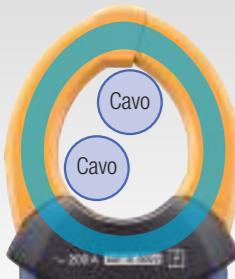
Accurata misura della corrente differenziale indipendentemente dalla posizione dei cavi nel toroide a sensibilità uniforme.
